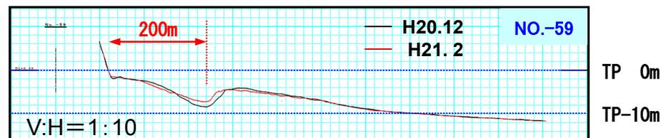
□ 汀線より200m付近の深み(トラフ、ダブ)に海中養浜による約1.0mの堆積
