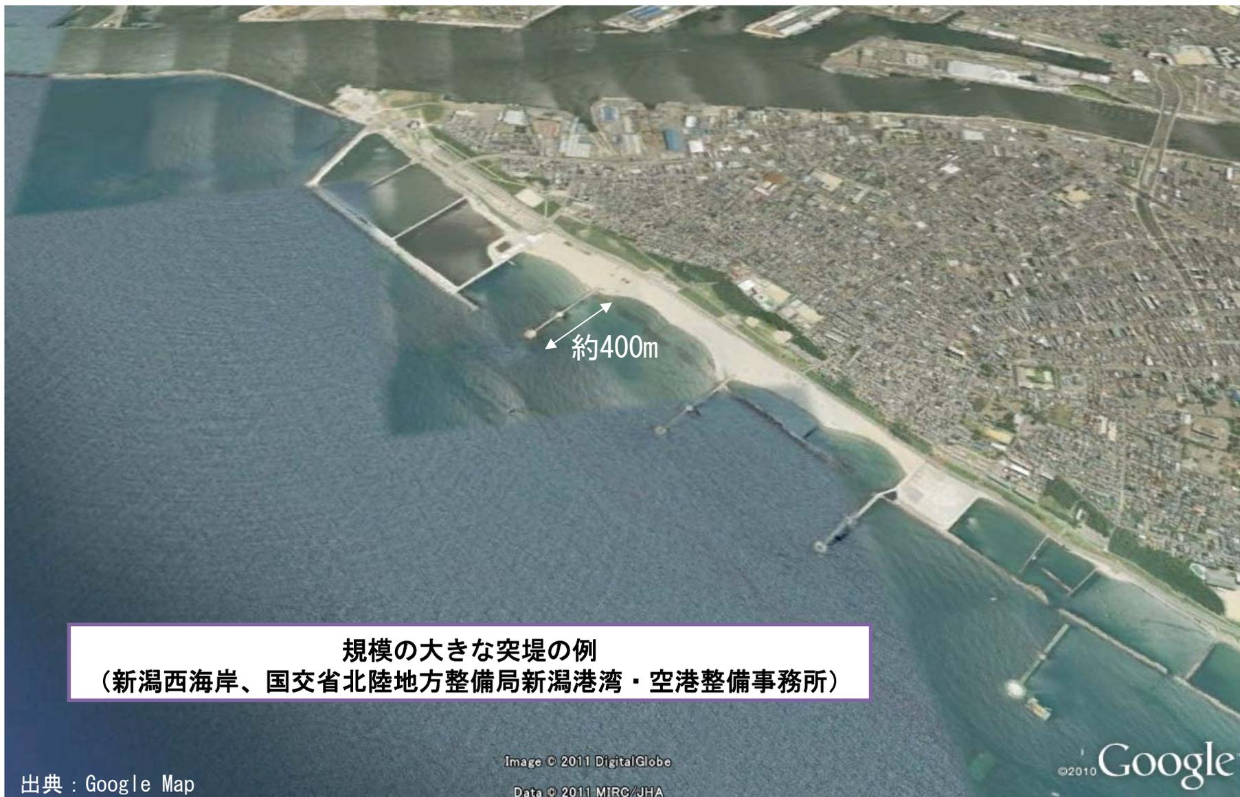
規模の大きな突堤の例
