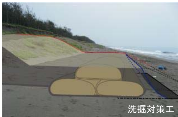
①洗掘対策工から露出する場合
