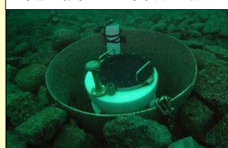
海底に設置した海象計で観測
