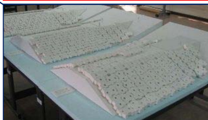
模型①：突堤ができることにより、砂浜の回復を含めた景観がどのように変化するかを表しているもの。
