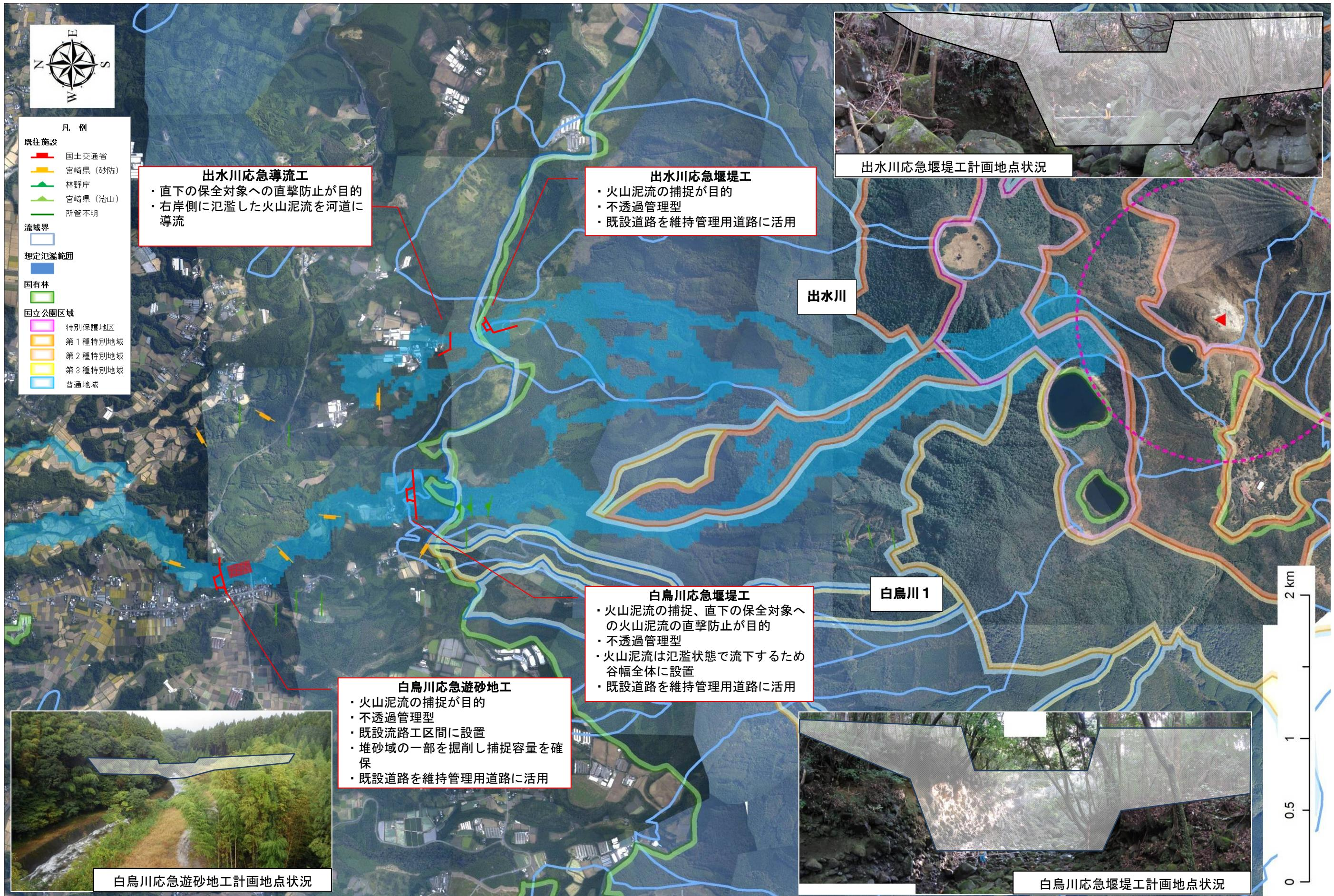
図 7-1 火口湖決壊型火山泥流の緊急減災対策（案） 六觀音御池
