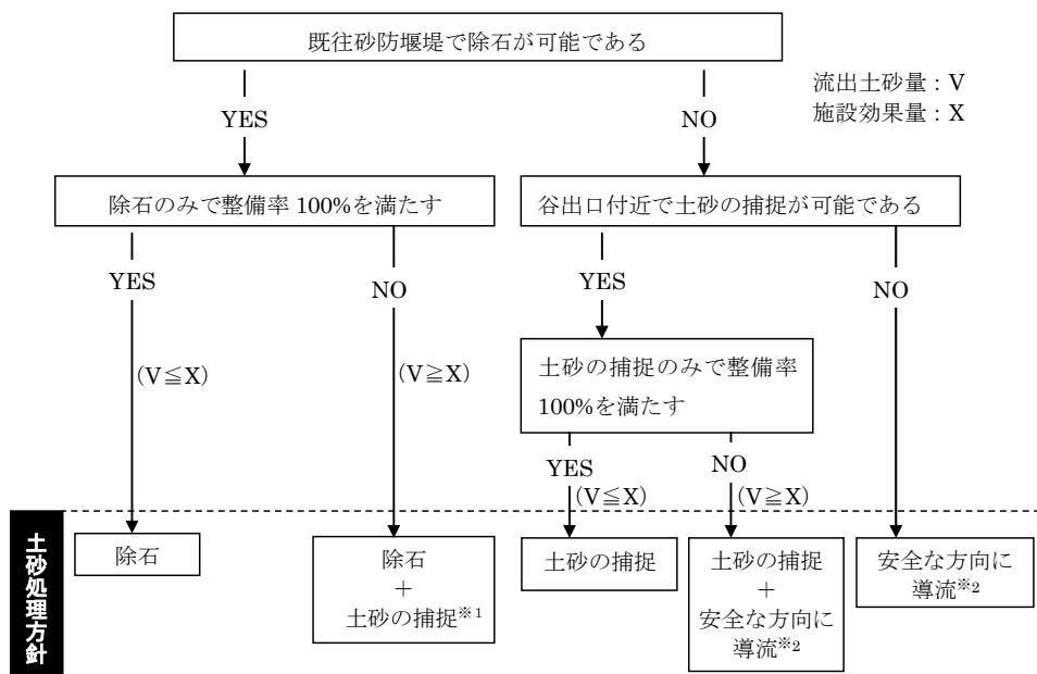
図 10 土砂処理方針の基本的な考え方
