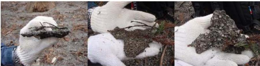
手の平サイズ程度の大きさでも、手にとることができ、自由に表裏を返しても崩れずに形状を維持する程度の硬さ。(写真左：断面、中央：表面、右：裏面)
