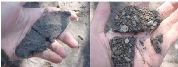
手の平サイズ～親指大のサイズで採取できても、指で触れると容易に崩れる程度の硬さ。(写真左：表面、右裏面)
