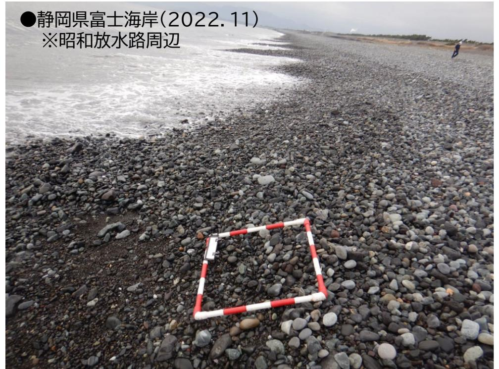
・川砂・川砂利のような混合粒径の養浜を行っている海岸では、礫がパッチ状に露出する場合もある。
