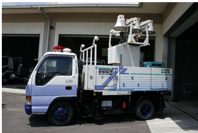
写真 4-3-14 夜間作業用の照明車
