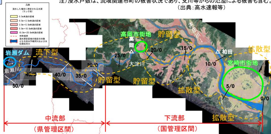
大淀川中下流部の氾濫形態(浸水想定区域図と航空写真の重ね図)
