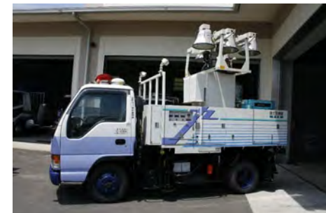
写真 4-3-14 夜間作業用の照明車
