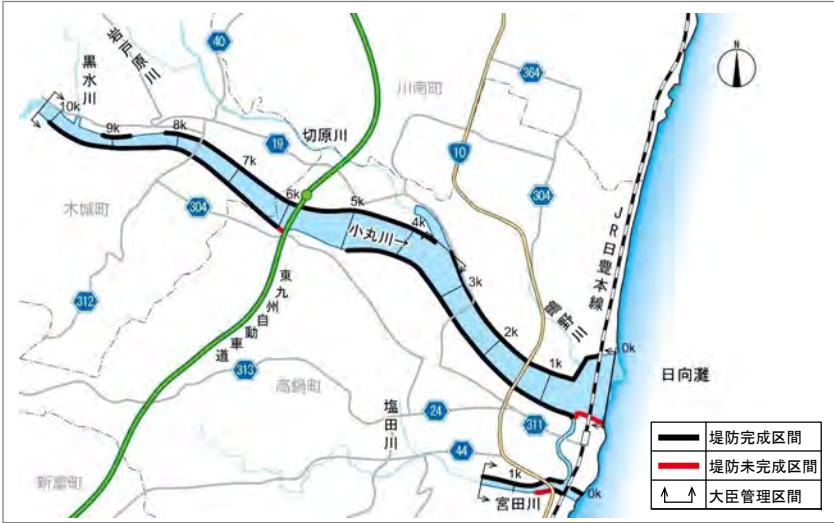
図 2-1-1 堤防整備状況
