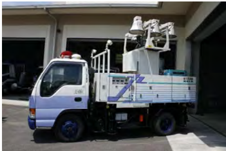
写真 4-3-14 夜間作業用の照明車
