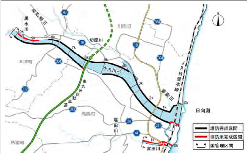
図 2-1-1 堤防整備状況
