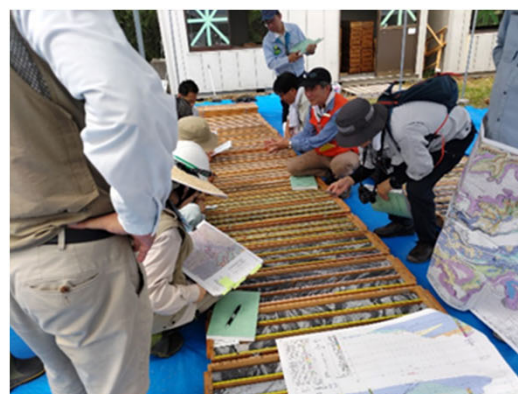
トンネル洪水吐きルート沿いの ボーリングコア観察の状況
