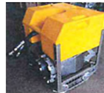
取水装置(水中ポンプ)
