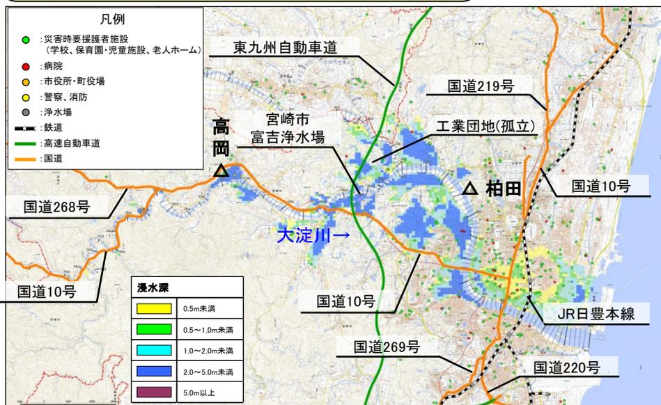
※整備計画目標流量規模の洪水が発生した場合のシミュレーション結果
