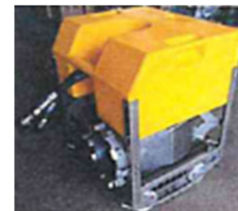
取水装置(水中ポンプ)
