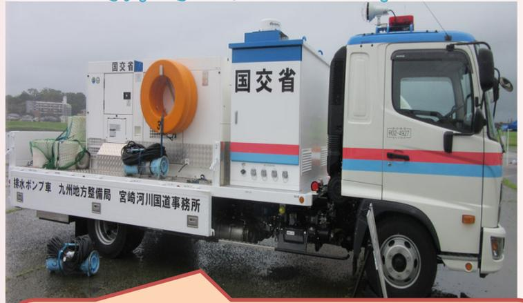
大雨により河川の氾濫が生じた際は、水中ポンプで素早く排水することにより、浸水被害を軽減します。
