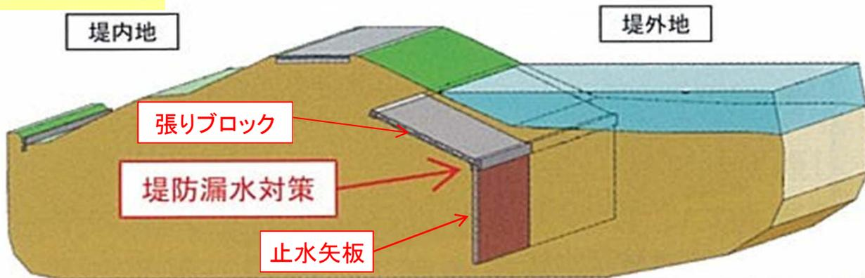
堤防の表のり面を難透水性素材で被覆することにより、高水位時の河川水の浸透を抑制します。また、堤防表のり面に止水矢板の遮水壁を設置することにより、基礎地盤への浸透水量を低減します。
