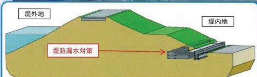
堤防に浸透した降雨ならびに河川水を裏のり尻のドレーン(排水誘導管)部に集水し、堤防外に速やかに自然排水します。
