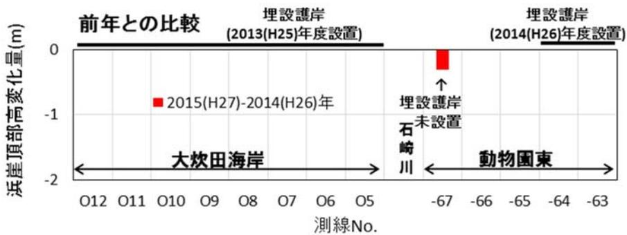
図一 3.16 浜崖頂部高の変化
