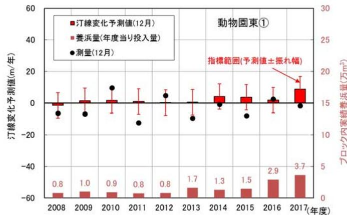
図－ 3.1 地形変化予測計算による汀線変化予測値と測量による汀線変化と指標範囲の比較結果例（補助突堤①北ブロック）
