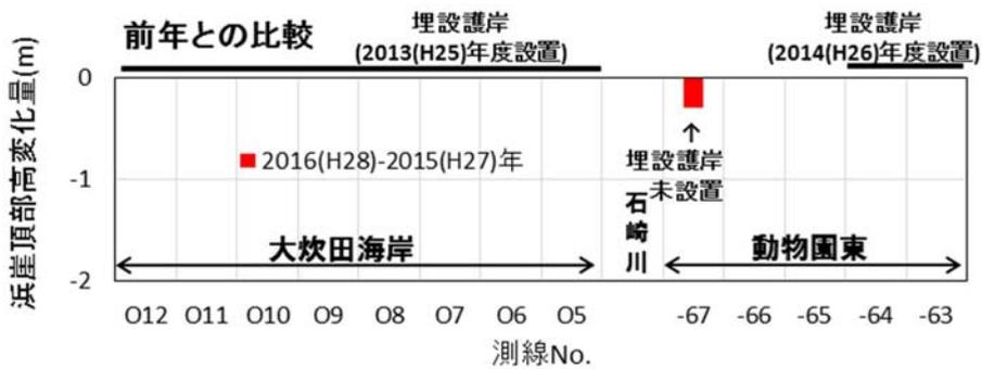
図- 3.14 浜崖頂部高の変化
