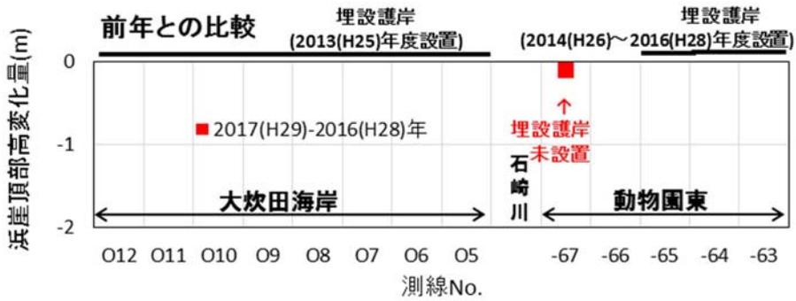
図- 3.12 浜崖頂部高の変化
