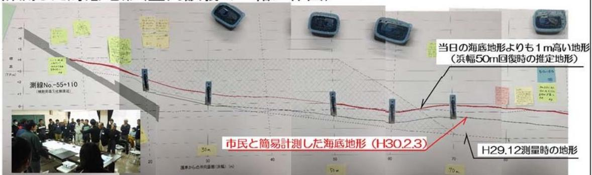
写真 補助突堤①周辺の断面地形を現地見学会で確認
