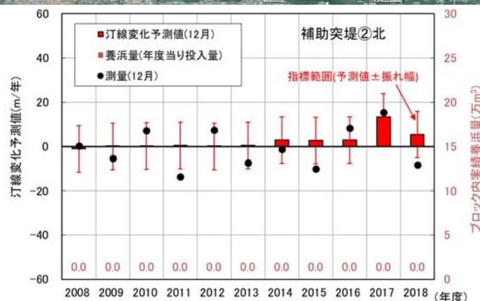
図一 3.2 地形変化予測計算による汀線変化予測値と測量による汀線変化と
