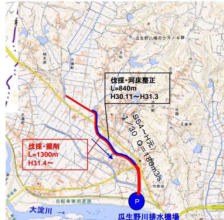
大淀川支川の瓜生野川、瓜田川、江川等において、河道内の土砂堆積や草本の繁茂が多く見られていることから、河道内の土砂掘削・伐採を行い、スムーズな水の流れを確保することで、支川の水を早く本川へ排水し、内水被害の軽減を図る。
