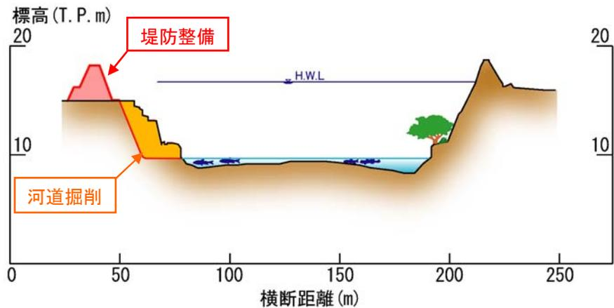
図 4-2-1 洪水対策のイメージ図
