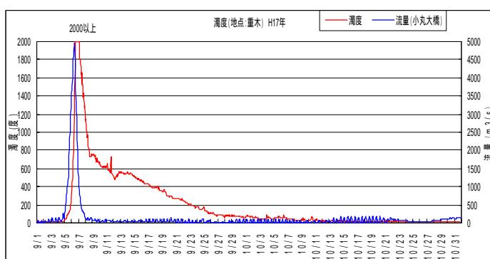
図 2-1-4 平成 17 年洪水後の濁水の長期化現象
