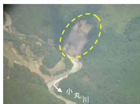
写真 2-1-7 小丸川上流部の山腹崩壊状況
