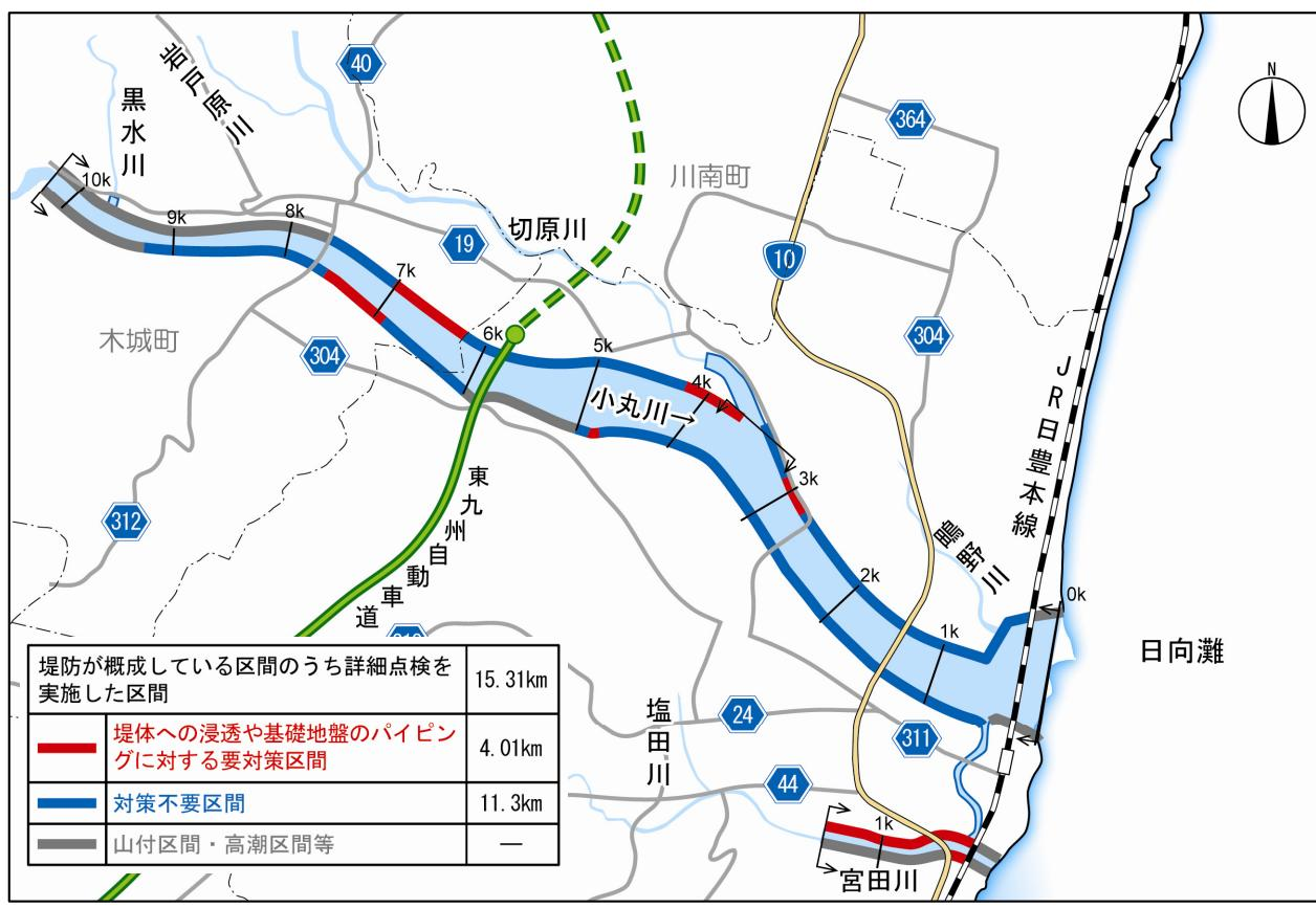
図 2-1-2 堤防詳細点検結果図
