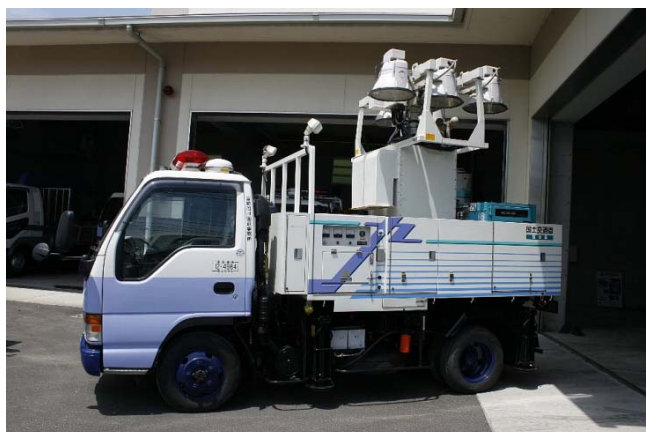
写真 4-3-14 夜間作業用の照明車
