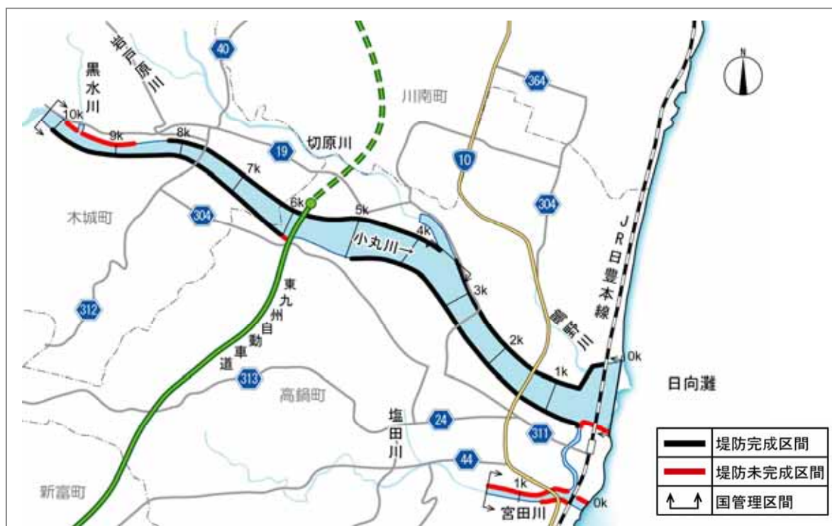
図 2-1-1 堤防整備状況
