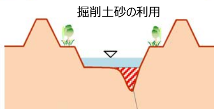
深掘れ箇所への土砂投入・埋戻し
