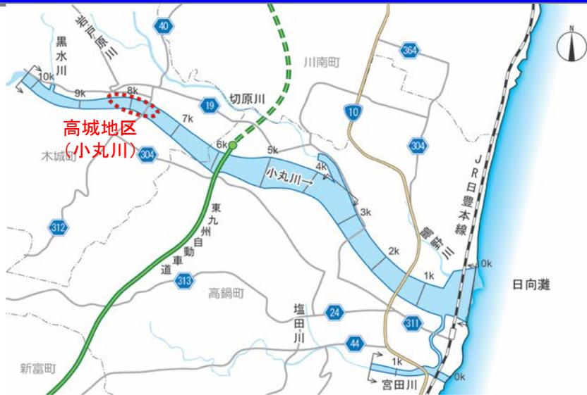
流下能力不足箇所でもある中流部（高城橋付近）は、小丸川の中でも特に流速が速く、出水の度に護岸等が被災。
