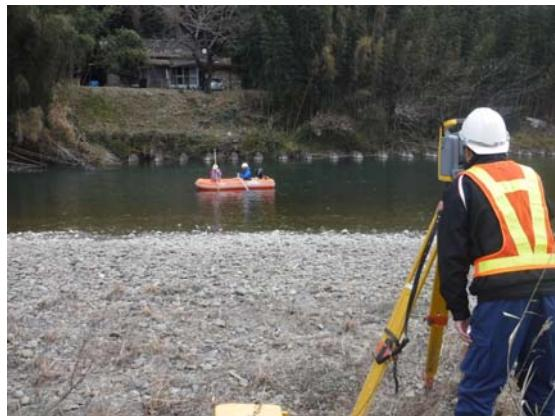
写真 5.2.1 河道の横断測量
