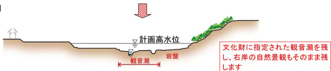
図 5.1.6 河道掘削の概要図(大淀川 51/050 付近)
