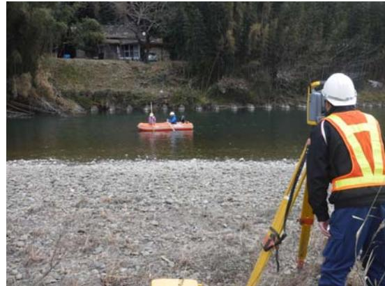
写真 5.2.1 河道の横断測量
