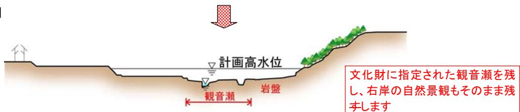
7 図 5.1.6 河道掘削の概要図(大淀川 51/050 付近)
