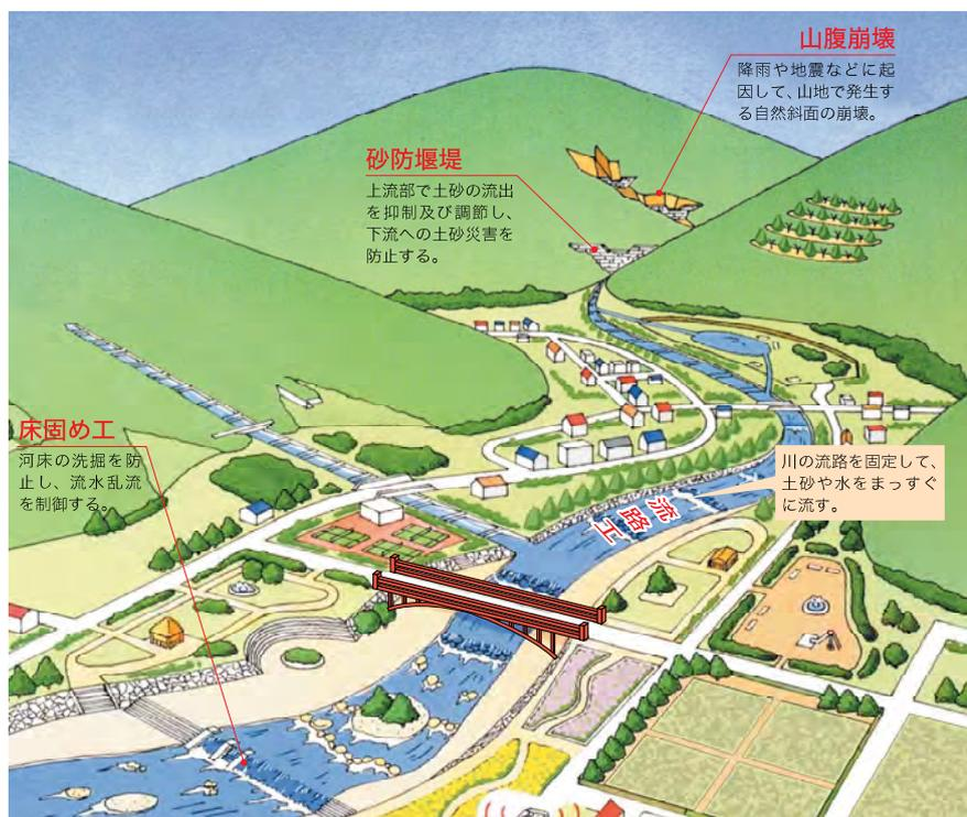
砂防施設は下流への土砂流出を軽減し、土砂災害を防止する
