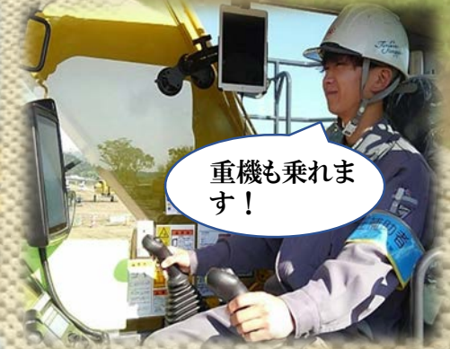
自社のICT建機に乗り、法面整形を行う様子。
