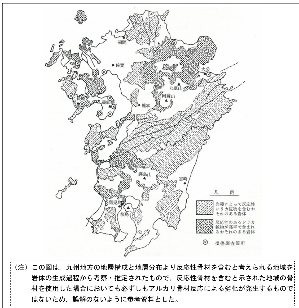
図 1.5 九州地方における反応性骨材の分布推定図
