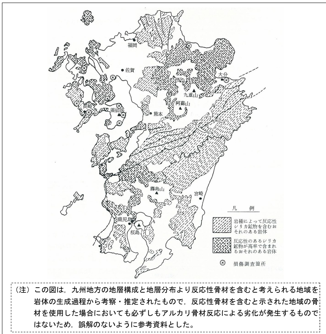
図 1.4 九州地方における反応性骨材の分布推定図
