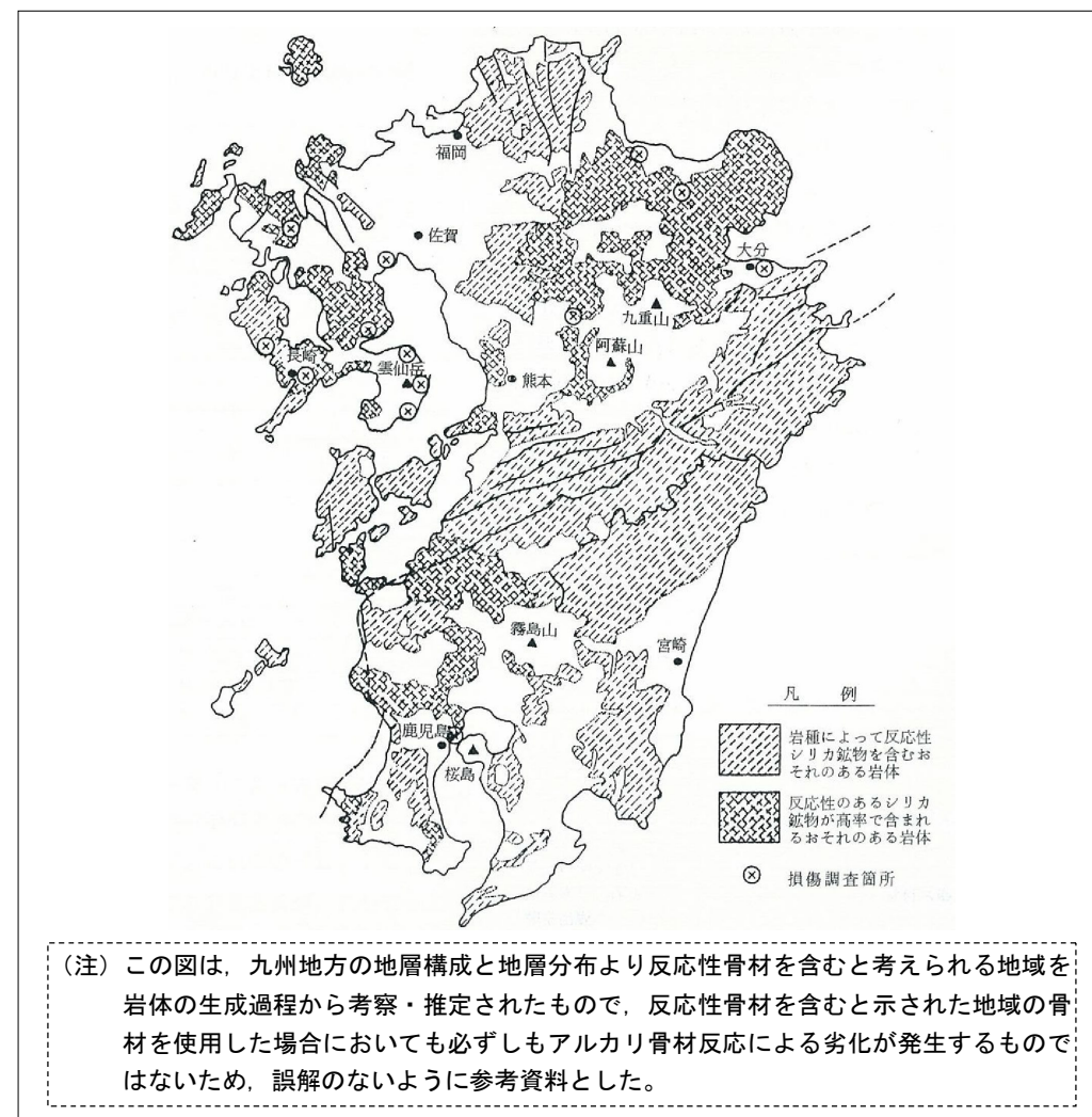
図 1.4 九州地方における反応性骨材の分布推定図 (出典：九州技報第 8 号)
