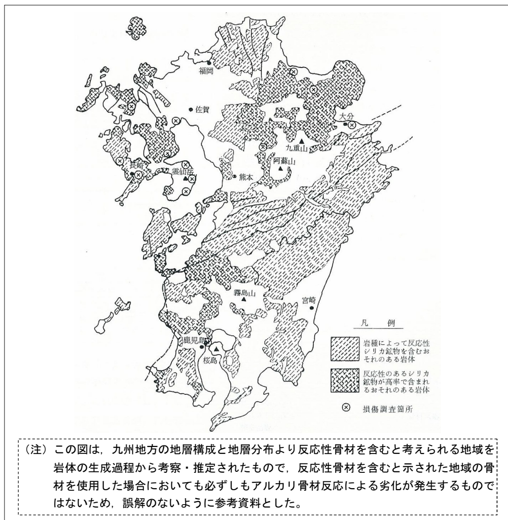
図 1.5 九州地方における反応性骨材の分布推定図 (出典：九州技報第 8 号)
