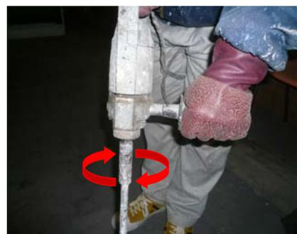
適切にハンドルを握り、作業工具を適正に使用する。
