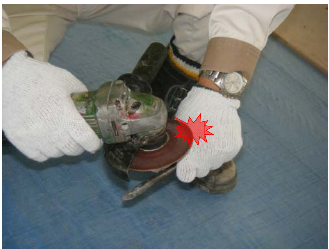
左手に「ノミ」、右手にディスクサンダーという不安定な状態での研磨作業を行った。
