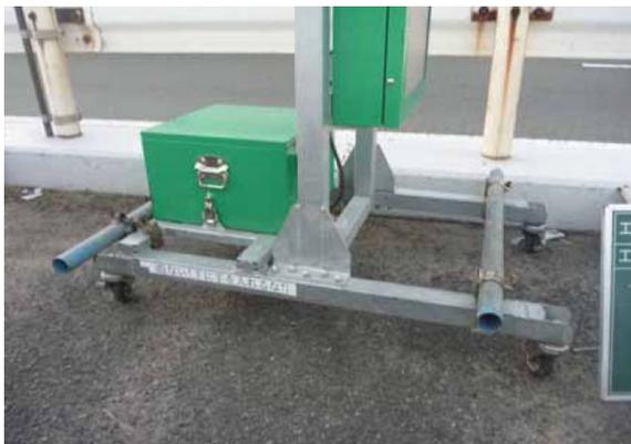
単管・クランプを用いた持ち手を設置し土台の下に手を入れないようにした。
