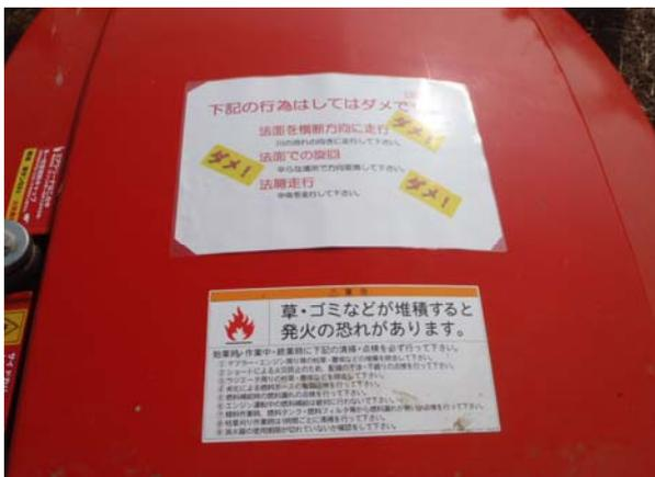
除草機械に注意喚起を掲示(斜面での旋回禁止・斜面横断方向への進行禁止等)し注意喚起をする。
