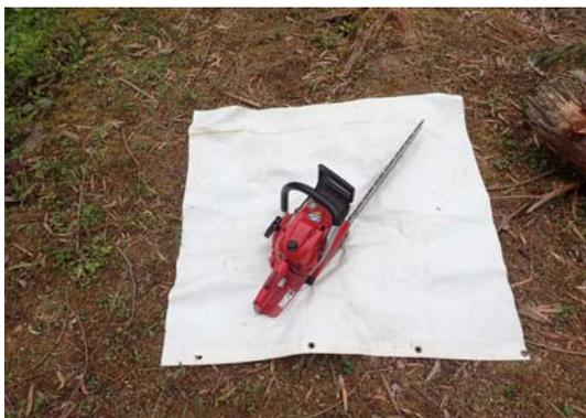
チェーンソーを仮置きする時はエンジンを停止し、防災シート(1m×1m)の上に置く。
