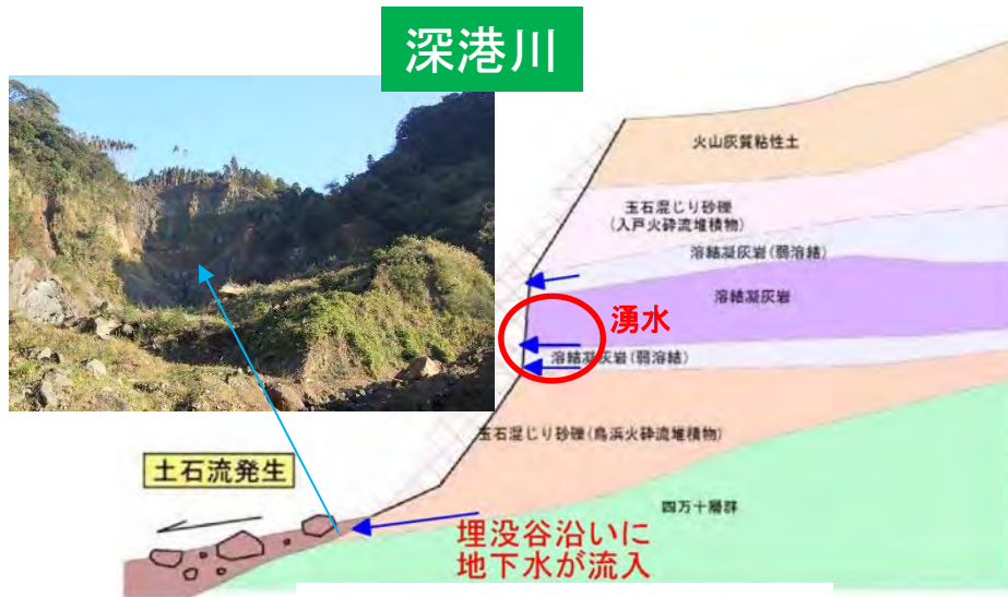
図1 深港川の地質断面図 (鹿児島県提供資料より)
