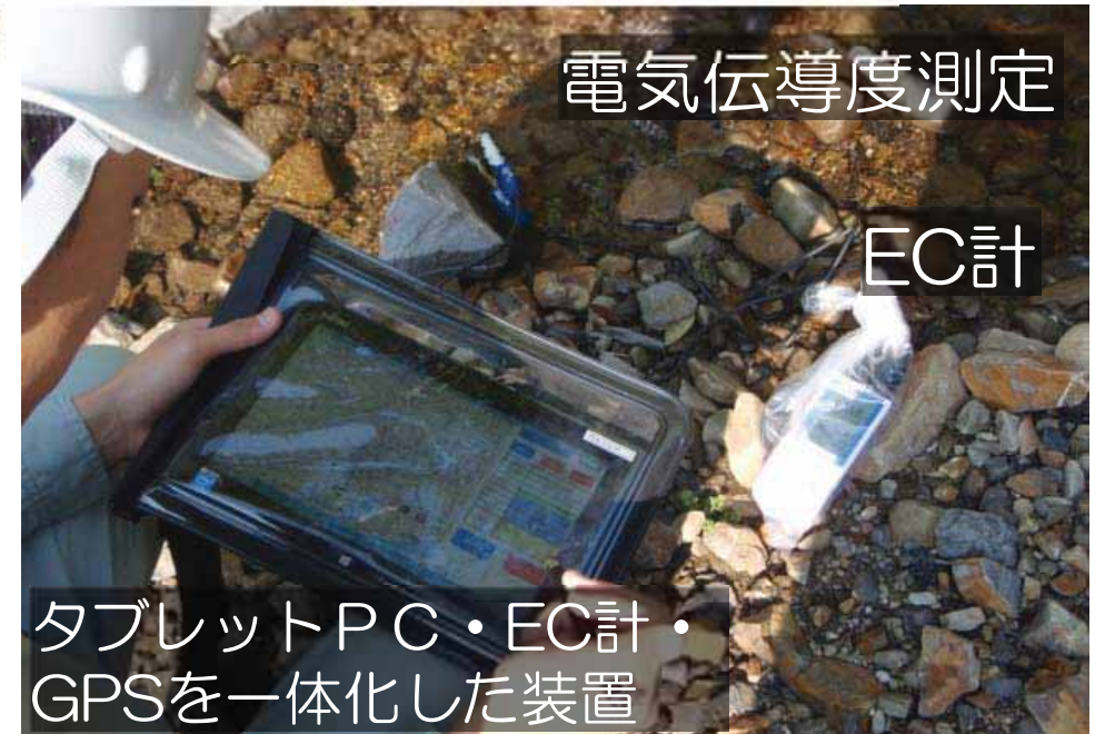
センサー情報はBluetoothでタブレットPCへ転送
