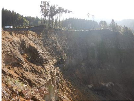
地形地質特性の確認 (崩壊斜面:溶結、非溶結、未固結の堆積物)
