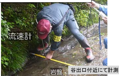
断面法による流量計測例(流速の計測)
