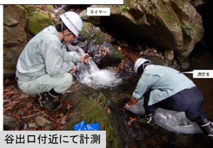
容器法による流量計測例
