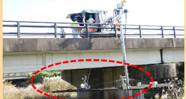
変状の自動検出、自動図化
