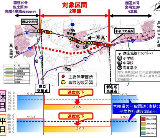
図2 国道10号対象区間の速度分布図(ピーク時間帯上下平均)
