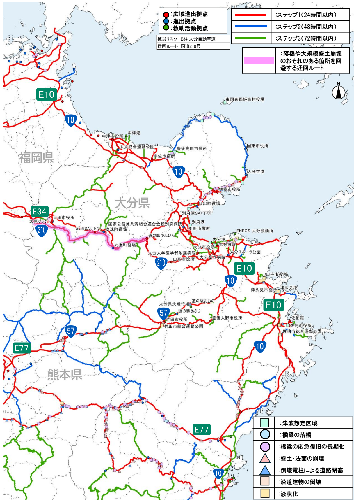
図 48 道路啓開ルートのリスク箇所（大分県）
