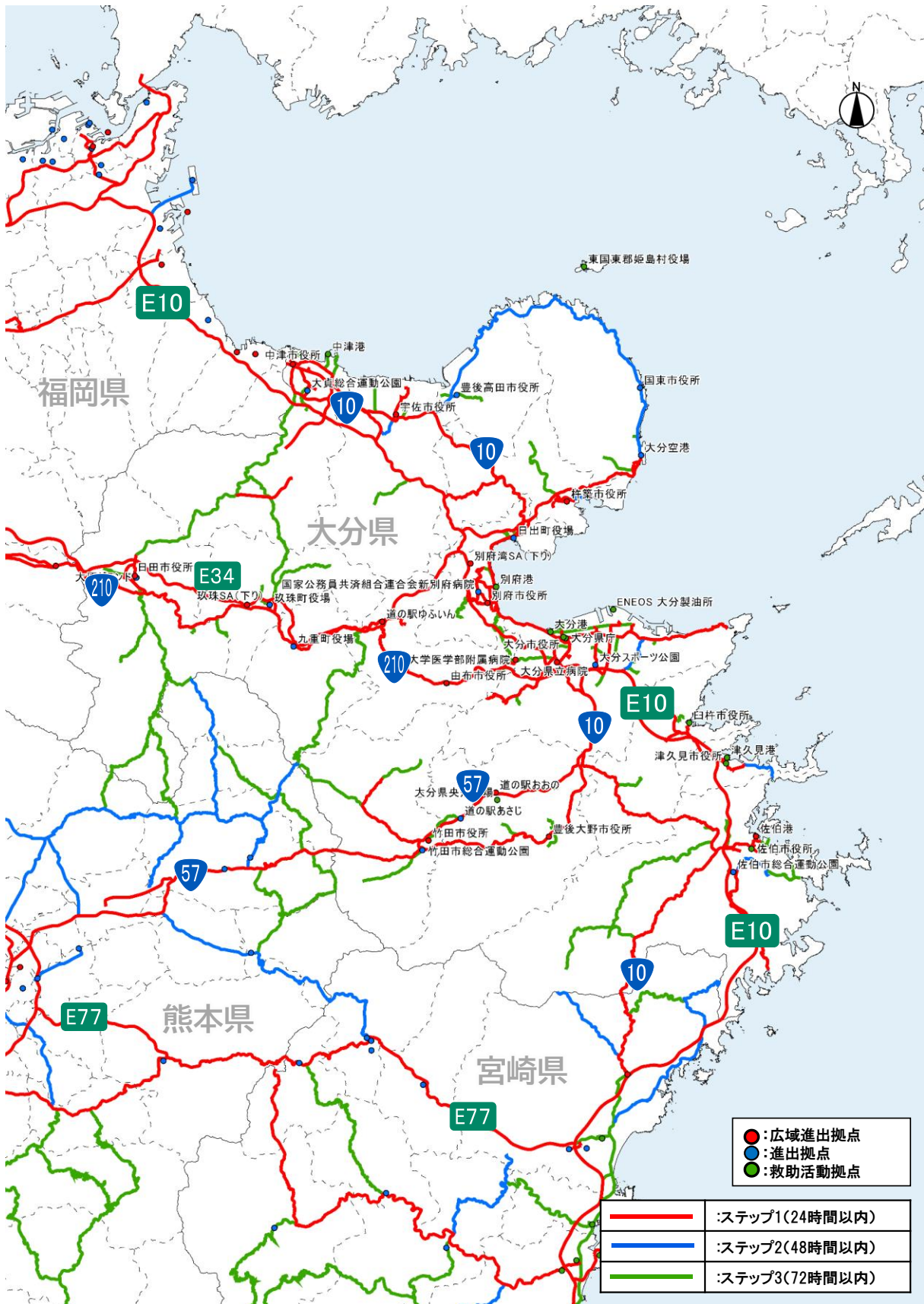
図 12 優先的に道路啓開を実施する路線・区間（大分県）
