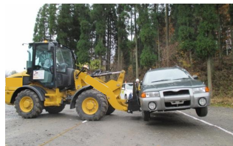
ホイールローダーによる車両移動 (アタッチメント装着)
