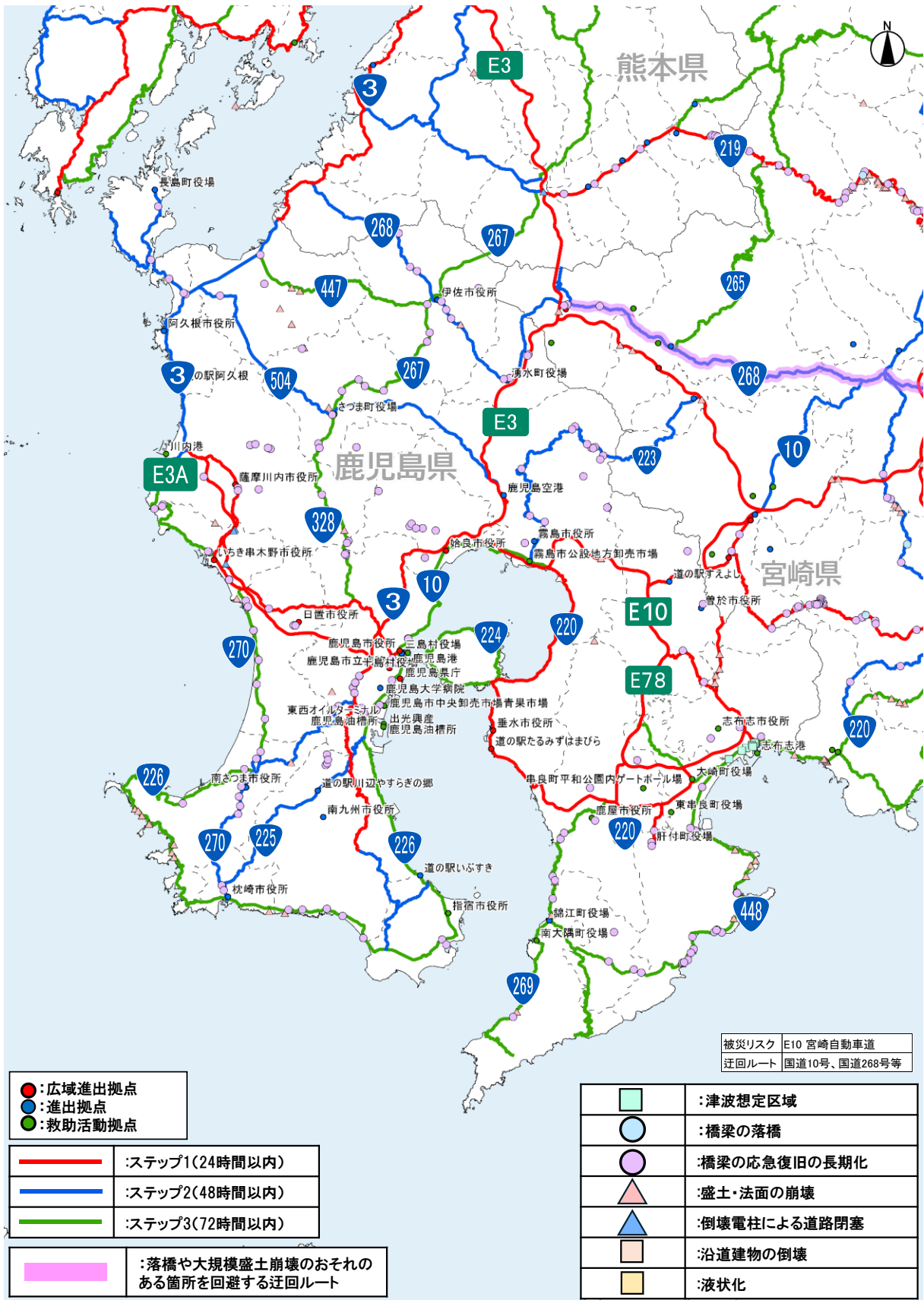
図 50 道路啓開ルート上のリスク箇所（鹿児島県）
