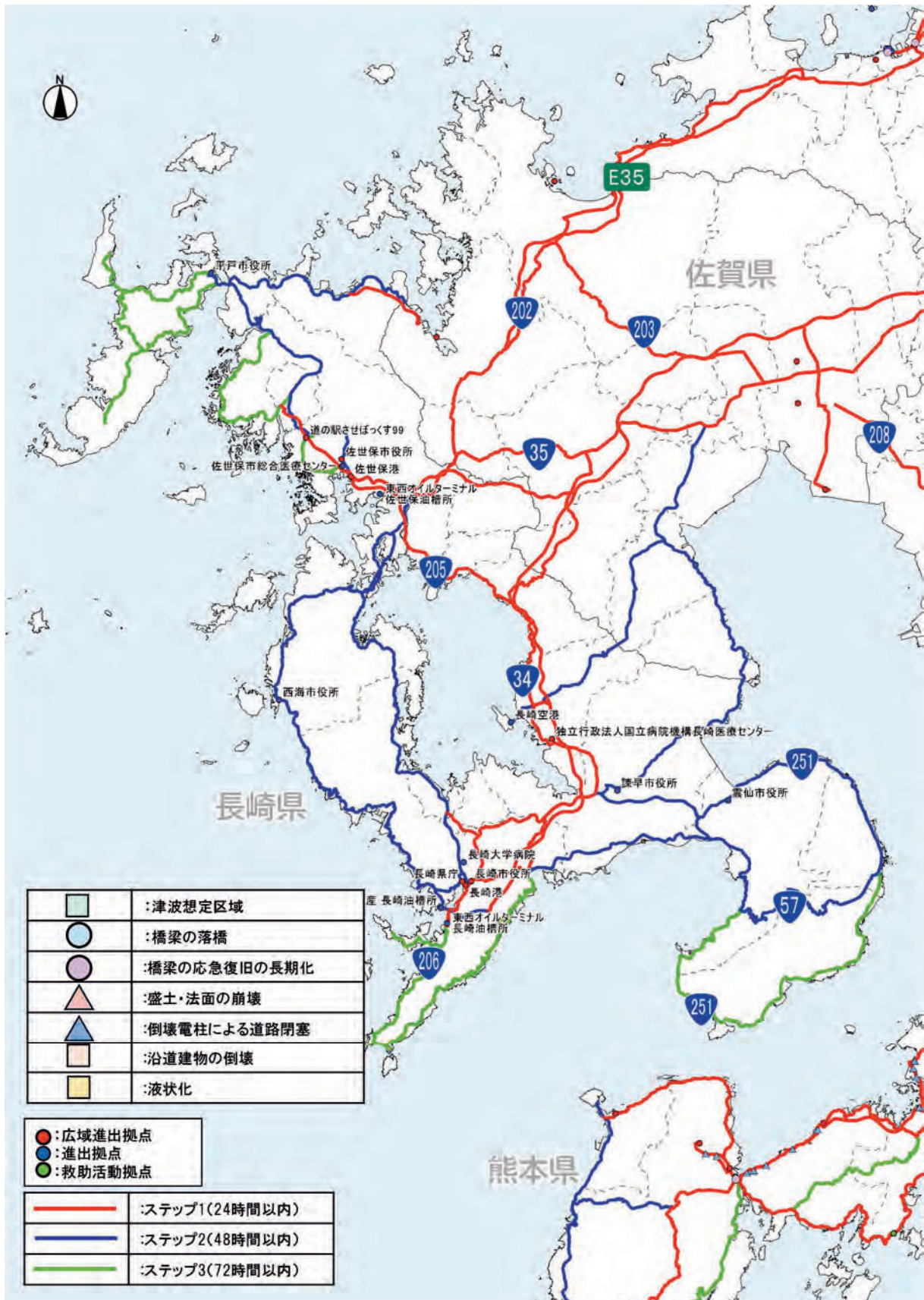
図 46 道路啓開ルートのリスク箇所（長崎県）
