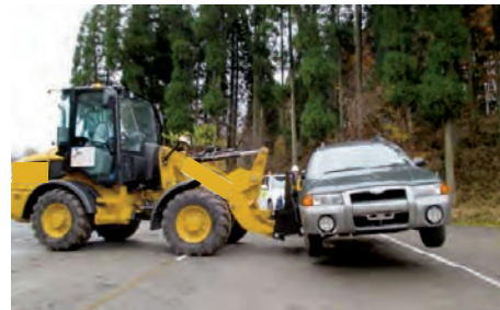
ホイールローダーによる車両移動 (アタッチメント装着)
