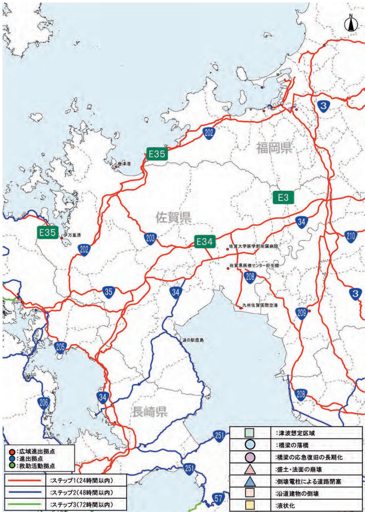
図 45 道路啓開ルートのリスク箇所（佐賀県）
