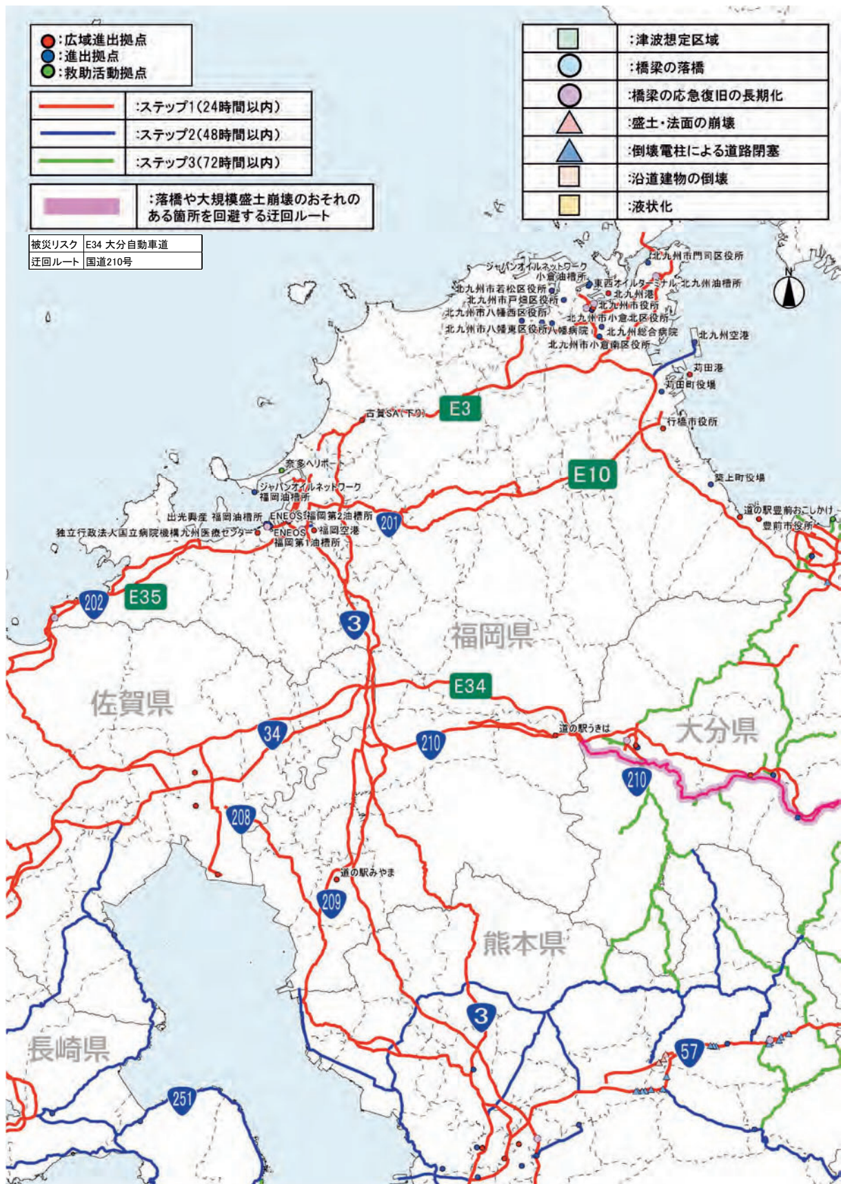
図 44 道路啓開ルートのリスク箇所（福岡県）
