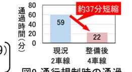
図9 通行規制時の通過時間の変化
