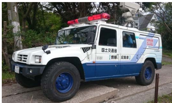
写真10 約20cmの段差を乗り越える情報収集車
