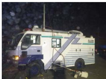
写真9 カメラポールが折損した九州技術衛星通信車（益城町役場）
