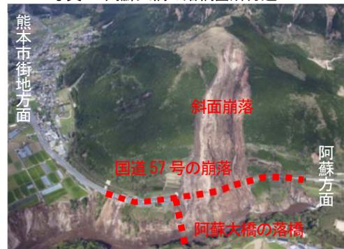
図-1 寸断された道路網（阿蘇方面）
