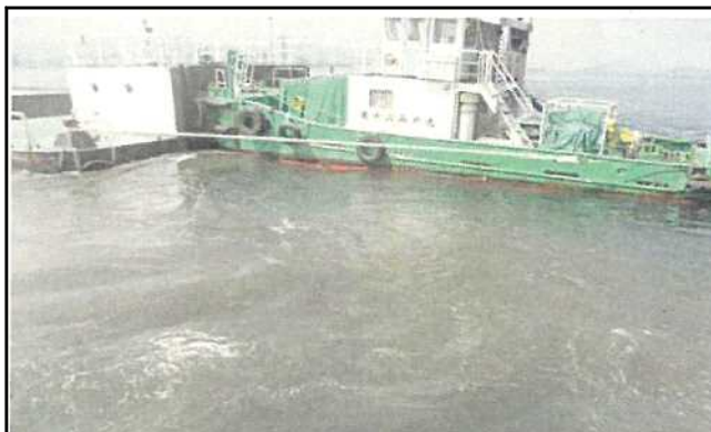
写真-2 スクリューによる巻き上げ状況 (濁り発生)
