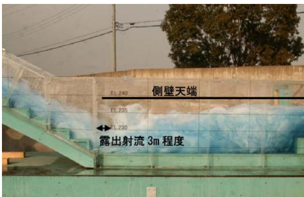
図-5(a) 減勢工の流況 (s=3.0m)
