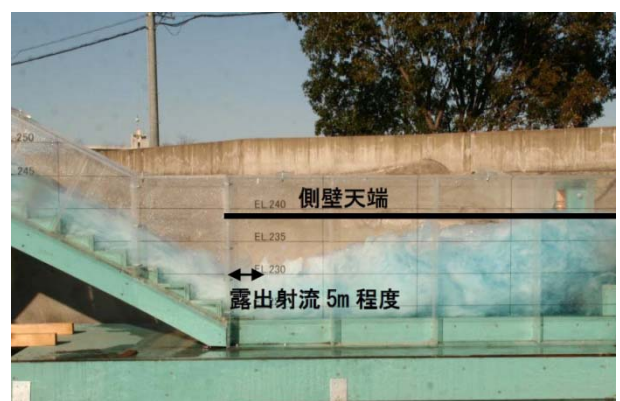
図-5(b) 減勢工の流況 (s=2.5m)
